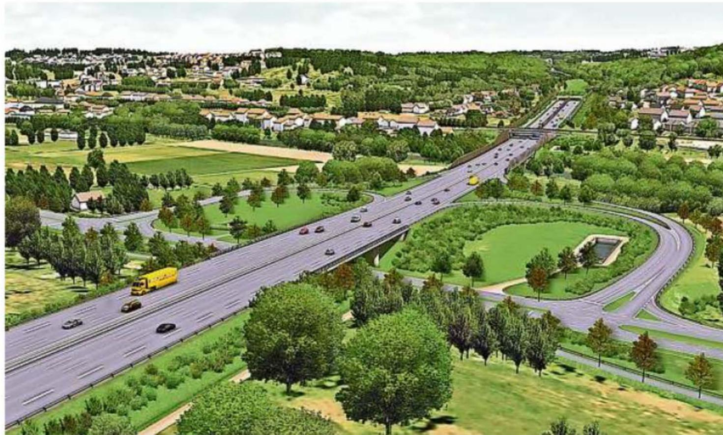
So soll die 340 Millionen Euro teure A8 im Enztal aussehen: Die Autobahn bekommt sechs Spuren und Standstreifen, Anwohner werden mit Wänden und einer 380 Meter langen Übertunnelung am Enzberg vor Lärm geschützt. ARCHIVMONTAGE: RP KARLSRUHE
